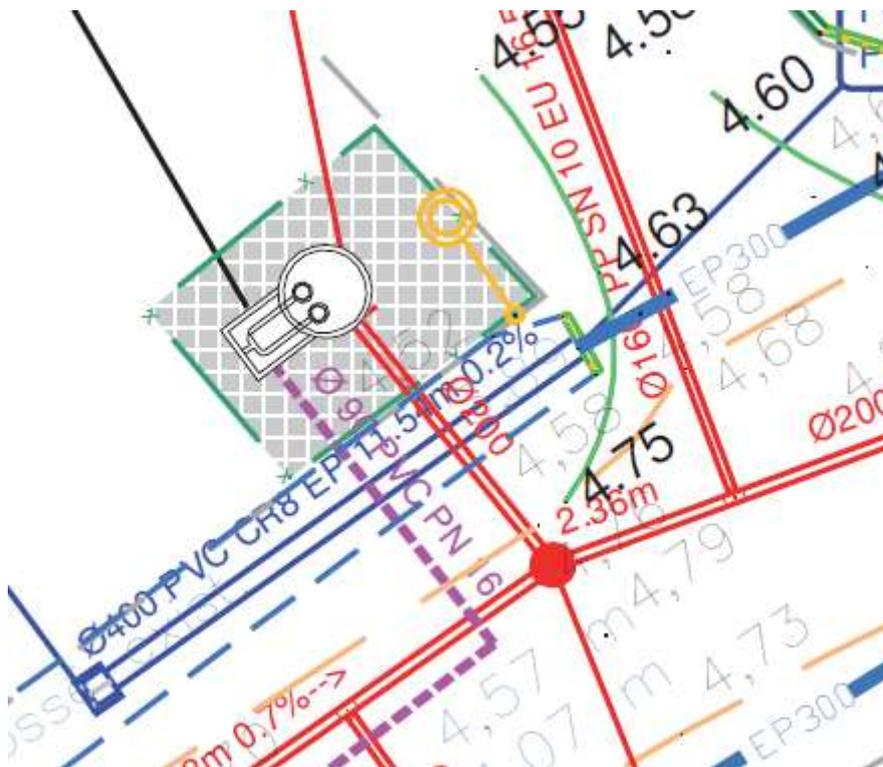
Cette acquisition permettra l'implantation d'un poste de refoulement qui aura pour fonction de collecter l'ensemble des effluents de la zone et de les envoyer vers le réseau existant par un système de pompe.
