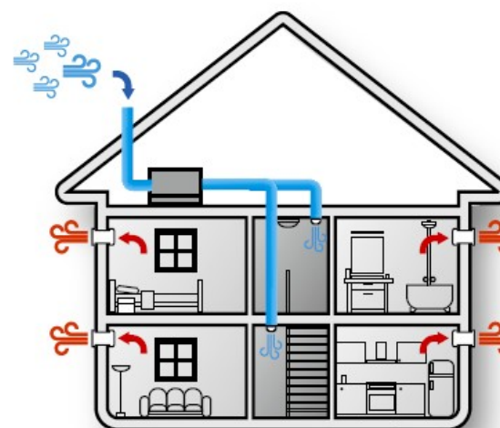
VIC : insufflation centralisée
